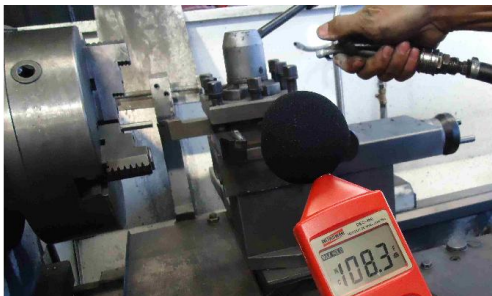
FIGURA 2. Limpeza utilizando jato de ar comprimido
