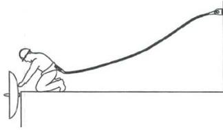
Entende-se por sistemas de ancoragem os componentes definitivos ou temporários, dimensionados para suportar impactos de queda, aos quais o trabalhador possa conectar seu Equipamento de Proteção Individual, diretamente ou através de outro dispositivo, de modo a que permaneça conectado em caso de perda de equilíbrio, desfalecimento ou queda.
