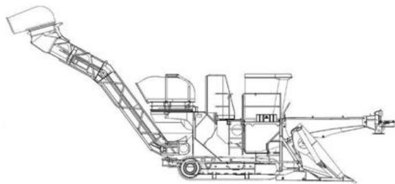
**Colhedora de forragem ou forrageira autoprovelida:** equipamento agrícola automotriz apropriado para colheita e forragem de milho, sorgo, girassol e outros. Executa o corte da planta, sendo capaz de colher ou recolher, triturar e recolher a cultura cortada em contêntores ou veíulos separados de transbordo.
