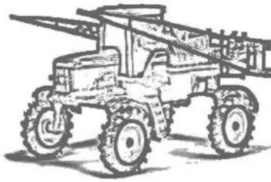
**Pulverizador tracionado:** implemento agrícola que, quando acoplado a um trator agrícola, pode realizar a operação de aplicar agrotóxicos.
